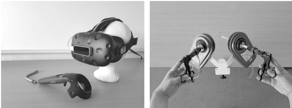
Abb. 1: Links: HTC Vive VR-Brille mit Leap Motion Sensor und ein Vive Controller (davor). Rechts: Simball-Eingabegeräte mit Greifwerkzeugen (ohne Kameramodul in der Mitte).
